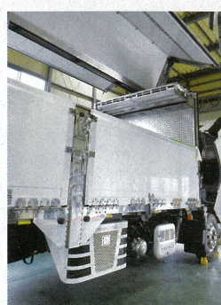
工場内で整備されている大型トラック。ウイング車の上部には冷凍機の冷気吹き出し口を、側面にはコンデンサーをそれぞれ装着する。
