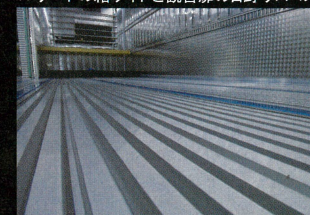
荷箱内部。床部や冷凍機の排気口上部までウロコステンレスが張り込まれており、美麗で清潔感あふれるイメージを創出している。冷凍機の機能面については第一に考えられてチョイスされており、仕切りをつけることで前面を低温、後部を中温にできるなど細やかな設定が可能。ジョルダンの格納は通常リア化粧板を切り欠いて付けるが、スッキリ見せるためオーバーハングサイドに搭載する。
