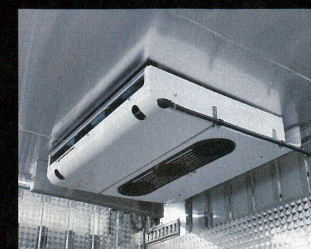
トラックの走行状態に左右されず、マルチ温度帯(複数温度管理)で温度維持を行うことができる冷却器S3型を搭載する。
