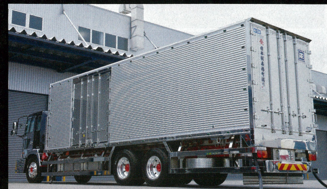
螺番やボルトのピッチ、箱メーカーの位置などをバランスを考慮して配置。リアビューではコルゲートの箱サイドと観音扉の日野ウロコステンレスが高級感あふれる表情を披露する。
