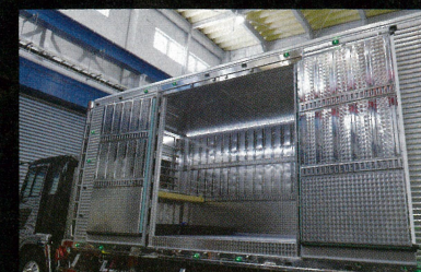
前部を低温、後部を中温にした場合に箱側面から積み降ろしができる構造となるサイドの観音扉。もちろん裏側や縁部分までキレイに日野ウロコが張られている。
